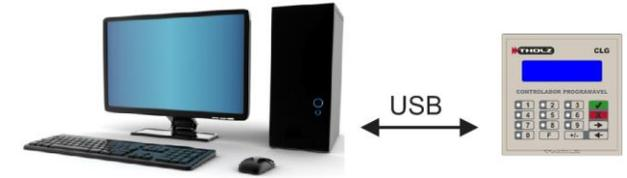
A transferência do programa elaborado no computador para o controlador CLG é realizado através de uma porta serial USB (compatível com V1.1 e V2.0) *Plug and Play*. Normalmente o Windows irá reconhecer o CLG e fará a instalação do driver automaticamente, criando uma porta COM, que poderá ser visualizada no gerenciador de dispositivos, conforme imagem abaixo.
